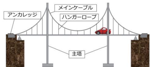
主塔間を渡るメインケーブルから垂らしたハンガーロープによって橋桁を吊る構造です。
