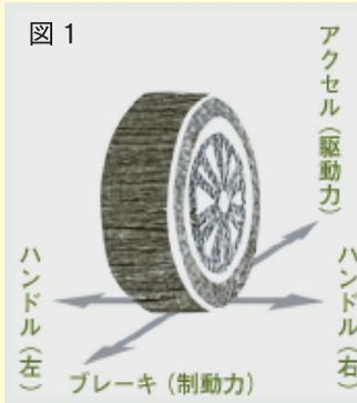
「直進専用」というクルマがあれば、タイヤのグリップ力は縦方向のみに働くこととなりますが…。タイヤには、ドライバーから要求されたアクセルのパワー（駆動力）、ブレーキのパワー（制動力）、左右のハンドルのパワー（コーナリングフォース）を受け止め、地面に伝える働きをします。
